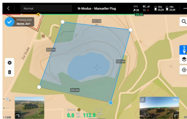
Abb. 12: Abmessen und automatisiertes Abfliegen von Flächen
